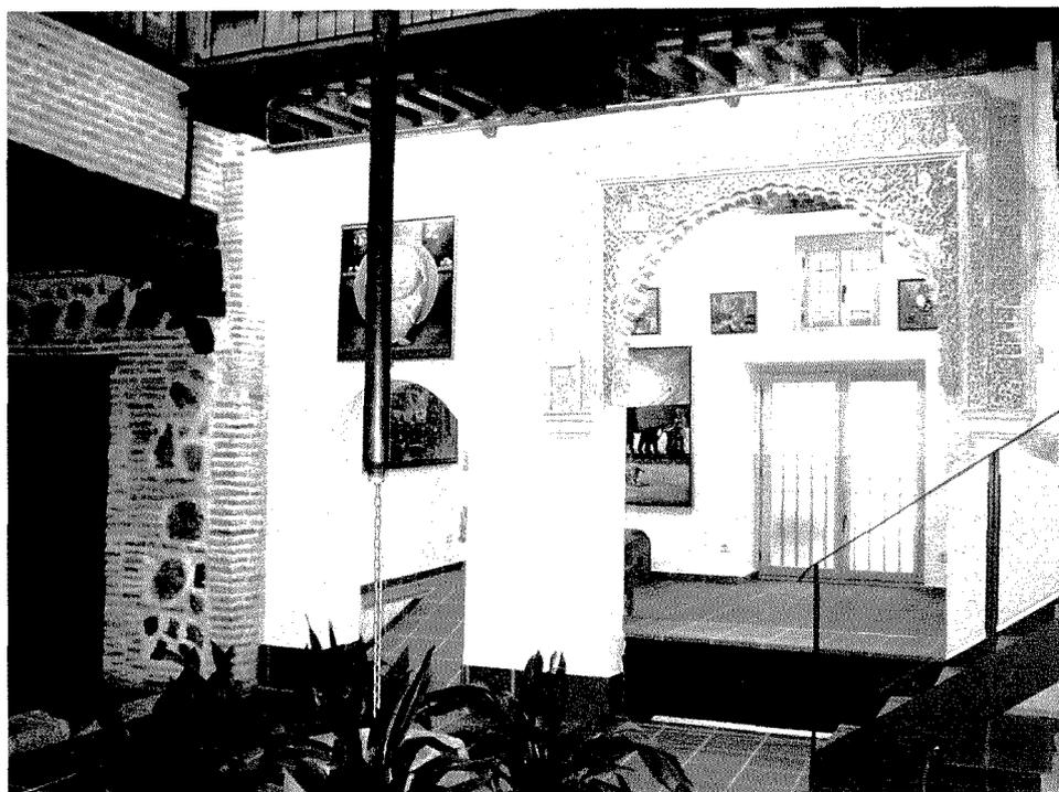
El arco de yesería es el elemento más destacado de la vivienda. Se construyó sobre antiguos arcos de herradura de uno de los cuales se aprecia la impronta.
